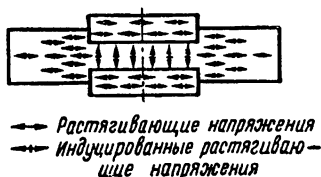
Рис. 2-15. Схема распределения растягивающих напряжений (непосредственных и индуцированных) после сплавления.
